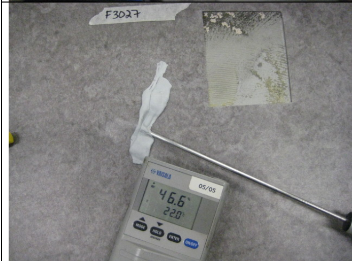
Kuva 2. Pinnoitteen alla olevat olosuhteet mitattiin Vaisalan mittarilla ja mittapäällä. Samalta paikalta otettiin materiaalinäyte pinnoitteesta, mistä analysoitiin VOC -yhdisteet. Kyseinen paikka on tilasta F3027 ja paikka on kuiva. Alue on lattiassa olevan sähkökaukalon ympäristö.
